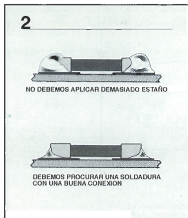
Figura 2.- Ejemplo de la forma correcta de soldar los componentes.
